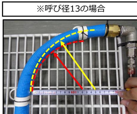
最小曲げ半径は、曲げ配管の内周側にて測定します。
