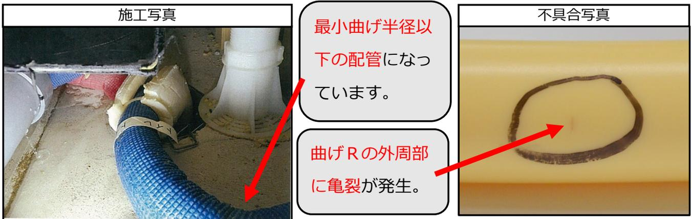
最小曲げ半径以下の曲げ配管をすると、
