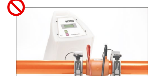
管をクランプで固定せずに融着作業はしないでください。
