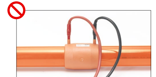
管をクランプで固定せずに融着作業はしないでください。
