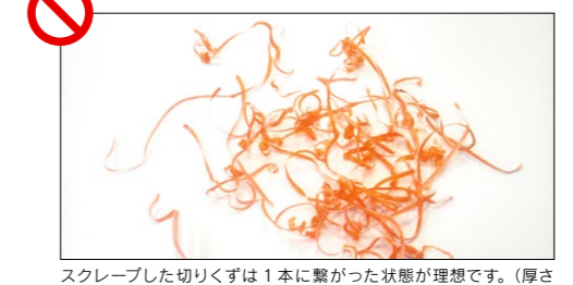
スクレープした切りくずは1本に繋がった状態が理想です。(厚さ0.1mm～0.2mm) 繋がらない状態が見られた場合はスクレーパーの刃の交換時期です。
