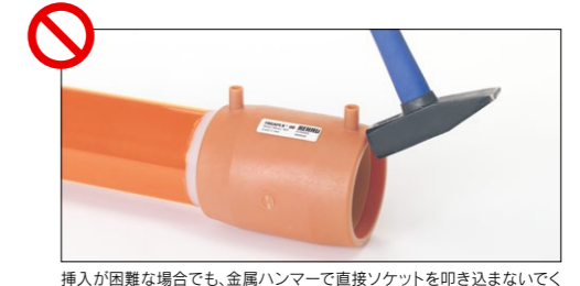
挿入が困難な場合でも、金属ハンマーで直接ソケットを叩き込まないでください。当木等を使用して適切な方法を行ってください。
