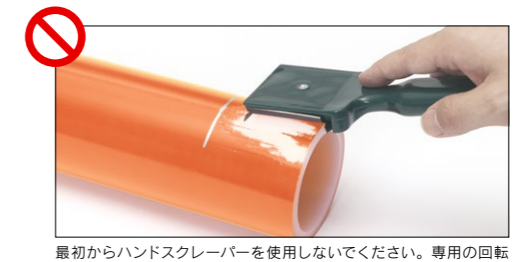
最初からハンドスクレーパーを使用しないでください。専用の回転式スクレーパーを使用してください。
