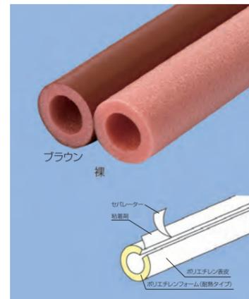
**脱・塩ビ商品** 連続使用配管温度 -40℃～100℃ 断続使用配管温度 120℃
