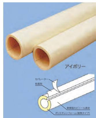
表皮軟質塩化ビニルタイプ 連続使用配管温度 -40℃～100℃ 断続使用配管温度 120℃
