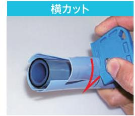
爪先端をパイプ表面に押し付けながらカットします。爪の構造上、必ず矢印(左回り)方向に回してください。
