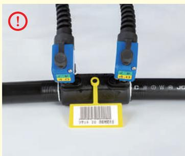
管にクランプを固定せずに融着作業をしないでください。
