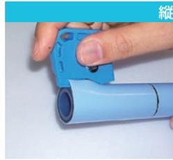
始めに被覆層(青紫色)をカットします。外層部に爪先端を差し込み、爪底面をパイプと平行に、押し付けるようにして、引きます。
