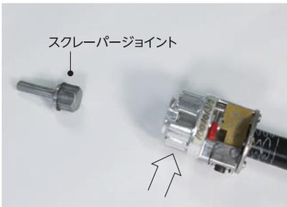
スクレーパーは管呼び径毎に用意されています。管先端をスクレーパーの刃先端部に合わせます。スクレーパー端部にスクレーパージョイントを差し込みます。
