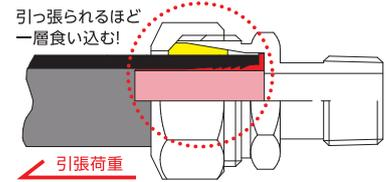
耐震インコアにより端面では平面ツバが管の変形を抑え、
