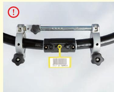
継手に曲げ等の力が加わらないように、真直ぐに固定してください。
