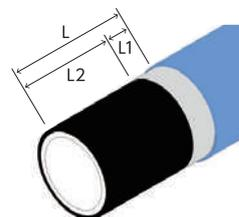
水道用ポリエチレン溶剤浸透防止被覆管の溶剤浸透防止層は必ずL1を残して仕上げてください。
