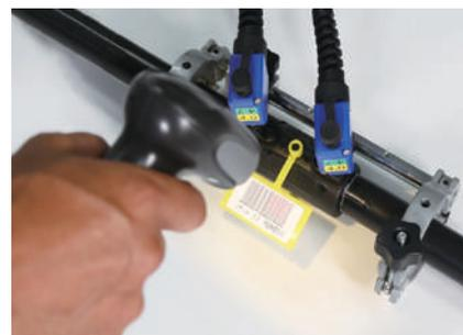
各継手に装着のバーコードをEFコントローラ付属のバーコードリーダーで読み込みます。
