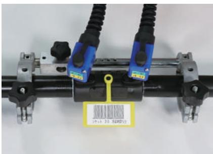
コントローラの電源プラグをコンセントに差し込み、電源を入れます。コントローラケーブルコネクタを継手のターミナルピンに接続します。コントローラの出カケーブルを継手の端子に差し込みます。
