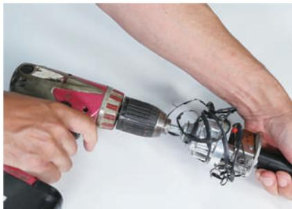
スクレーパーを電動ドリルに取付け、回転させて管の表皮を切削します。管端が、スクレーパーの端部に当たるまで切削します。切削が完了したらスクレーパーを取り外します。
