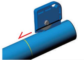
爪底面をパイプと平行に、押し付けるようにして引いてください。
