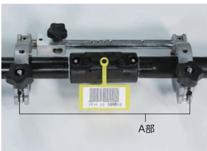
継手に双方の管を標線位置まで挿入します。クランプのA部のつまみを緩め、アーム部を開放し、管をセット後にA部を締め付けて、管を固定します。
