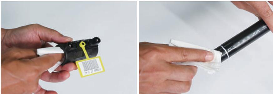
洗浄液(アセトン・エタノール)を浸み込ませたペーパータオル(キムワイブ・JKワイブ)につけて、継手内面全体を清掃します。また、継手と同様にパイプの切削表面も清掃します。
