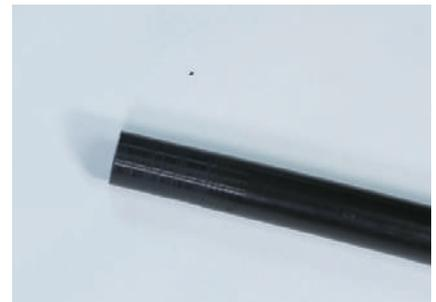
切削前に記入したマーキングが完全に消えていることを確認します。もし、削り残しがある場合は、手カンナで切削します。
