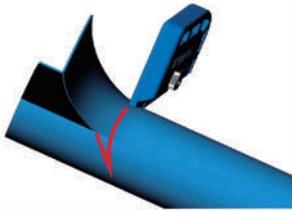
爪の構造上、必ず矢印(左回り)方向に回してください。反対方向に回すと、カットがしづらく、場合によっては爪が破損する恐れがあります。やりにくい場合は、ハサミ等でカットしてください。
