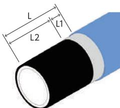
水道用ポリエチレン溶剤浸透防止被覆管の溶剤浸透防止層は必ずL1を残して仕上げてください。ナイロンテープ(別売)で端末を仕上げる際に、テープ貼り代が必要になります。
