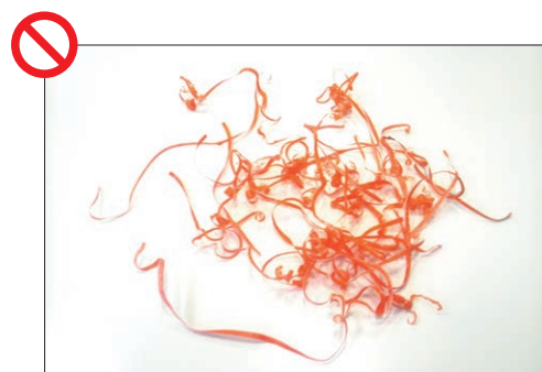
スクレーブした切りくずは1本に繋がった状態が理想です。(厚さ0.1mm～0.2mm) 繋がらない状態が見られた場合はスクレーパーの刃の交換時期です。
