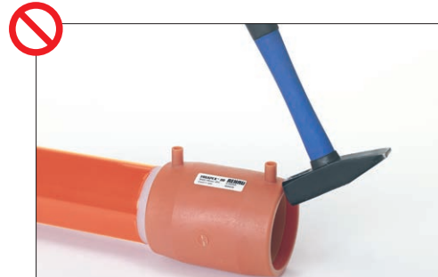
挿入が困難な場合でも、金属ハンマーで直接ソケットを叩き込まないでください。当木等を使用して適切な方法を行ってください。
