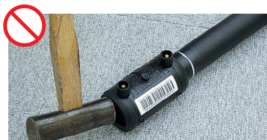
挿入が困難な場合でも、金属ハンマーで直接ソケットを叩き込まないでください。当木等を使用して適切な方法を行ってください。
