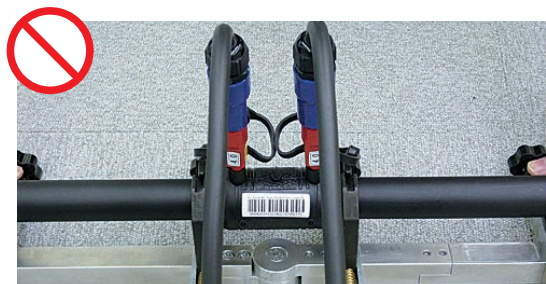
通電中はケーブルに力が加わらないようにしてください。
